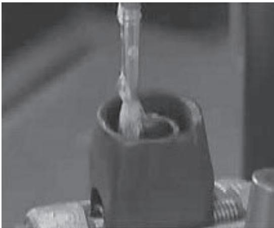
図 6.1 容器のガス漏れ点検<sup>1)</sup>
