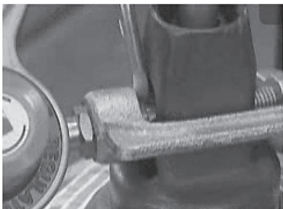
図 6.2 容器と圧力調整器の接続部のガス漏れ点検<sup>1)</sup>
