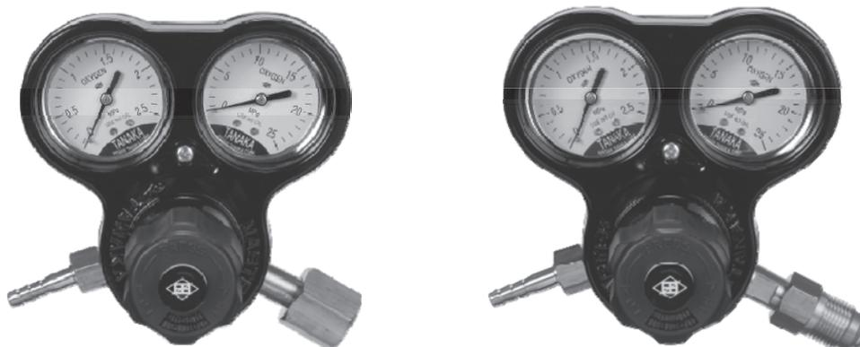
入口側（画面右側）：ドイツ式（取付ナット）      入口側：フランス式（取付ネジ）
