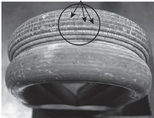
図 6.4 亀裂が見られるホースの例
