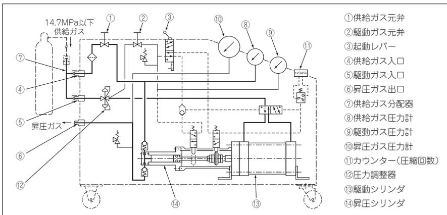
本器は駆動シリンダの断面積×駆動圧力と昇圧シリンダの断面積×昇圧圧力の比によりシリンダを作動させ、供給ガスを圧縮して昇圧する構造です。
